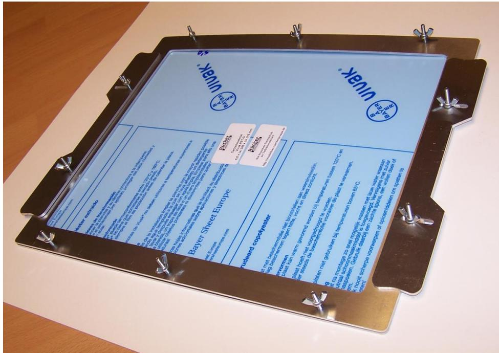
4. Alle Flügelmuttern gut handfest anziehen, sodass das Tiefziehmaterial gut fixiert ist. Es genügt dabei die Schraubenköpfe mit dem Finger zu fixieren, während Sie die Muttern anziehen!
